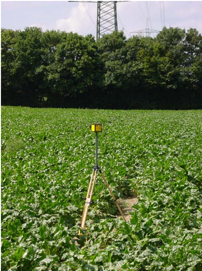
Abb. 7: Messung des elektrischen Feldes
