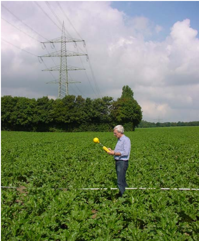
Abb. 6: Magnetfeldmessung (1,5 m Höhe)
